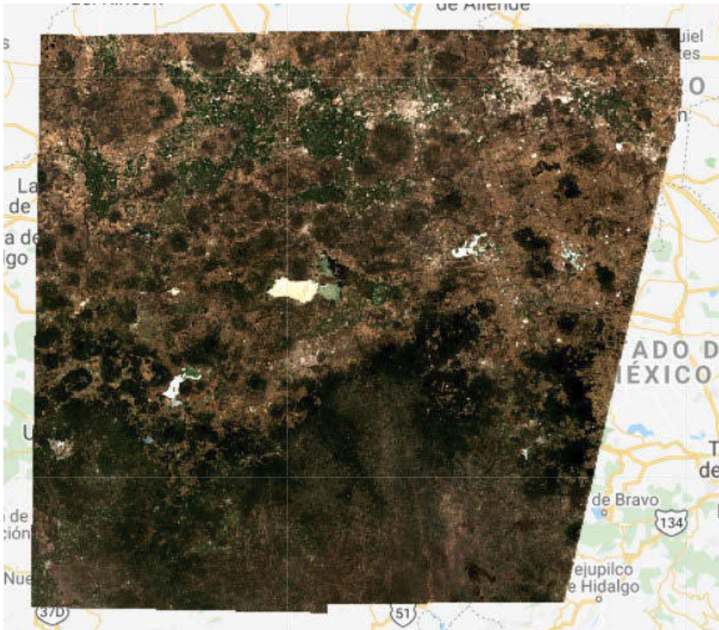
Figura 10.13: Visualización de la imagen de la reflectancia promedio con el método de mosaico de calidad (compuesto RGB).
