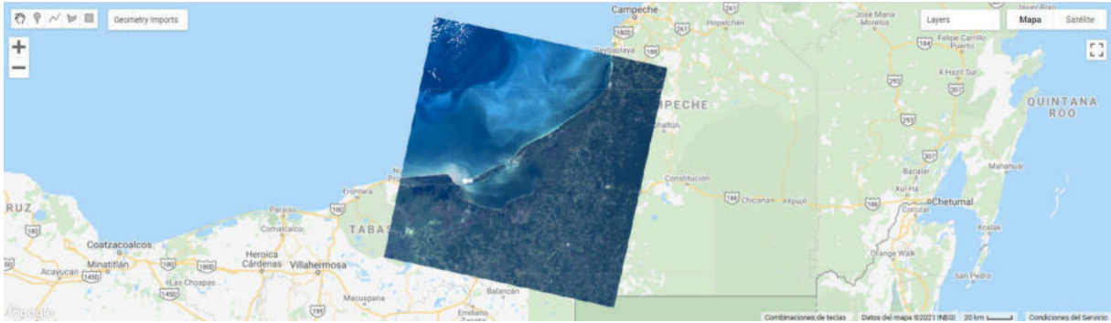
Figura 3.2: Ejemplo de visualización de un compuesto RGB de una imagen Landsat 8 sobre Laguna de Términos, México.
